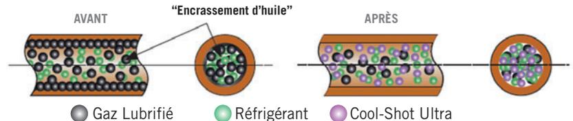
COOL-SHOT ULTRA est composé de deux catalyseurs synthétiques et d'un agent lubrifiant. S'il est utilisé de manière préventive, il empêche l'huile de se déposer sur les parois du système. S'il est plutôt utilisé de manière résolutive, il élimine l'huile qui s'est déposée sur les parois du système au cours des années d'utilisation, il solubilise l'huile et la ramène au compresseur.
